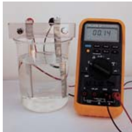
Una disolución de agua salada al cinco por ciento indica un bajo voltaje entre la aleta de aluminio Spine Fin™ y la tubería de aluminio.
