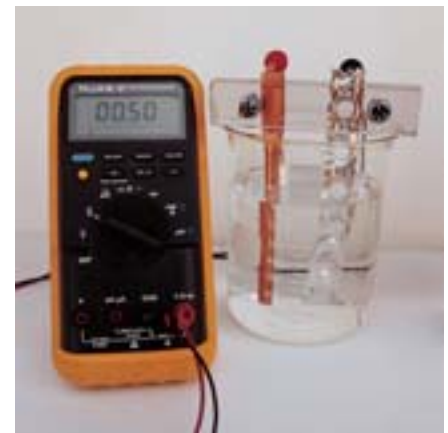
Una solución de agua salada al cinco por ciento indica un voltaje significativo entre el aluminio de la aleta plana y la tubería de cobre.
